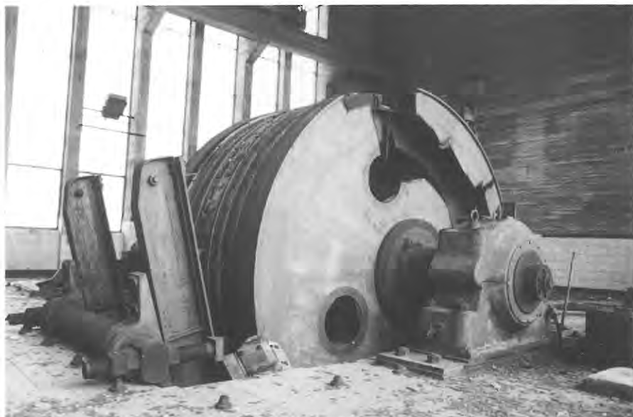
Fig. 11. Farciennes – Siège du Roton-Ste-Catherine : machine d'extraction à poulie koepe quadricâble du puits n°5 (1960).
