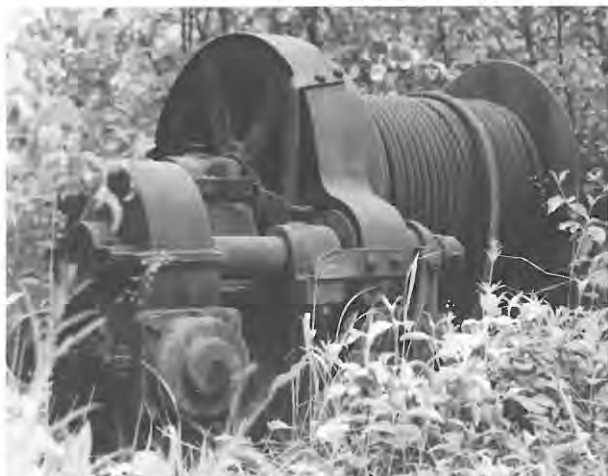
Fig. 5 Treuil électrique de la carrière RIVIERE. (Photo Jean-Pierre Ducastelle)
