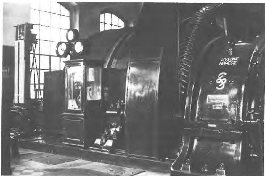
Puits «Irena». Machine d'extraction électrique de 1903 de système Leonardo-Ilgner travaillant dans la halle des machines.
