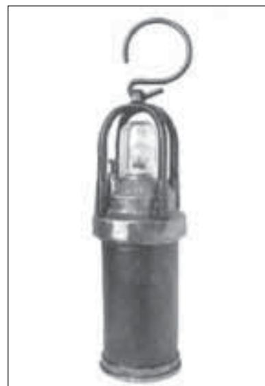
Fig. 13. - Lampe électrique «brevetée Lemaire».
